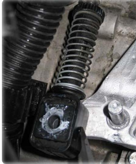
Jetzt mit z.B. einer Ratsche, Verlängerung(en) und einer 13er Nuss die Schaltgabel lösen:
